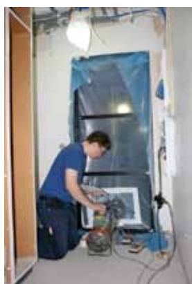
IMATGES DE CONTROL D'ESTANQUITAT I DEL PROCÉS DE CONSTRUCCIÓ
